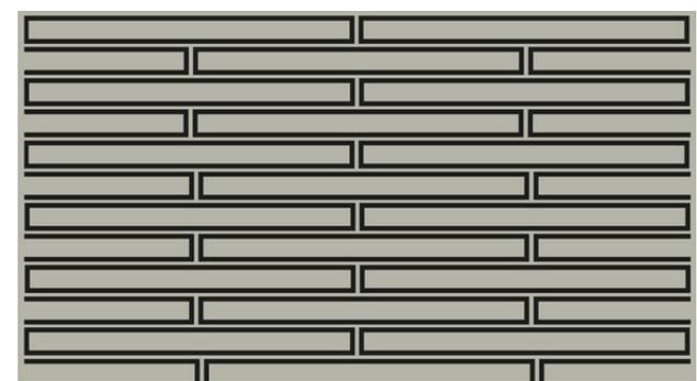
Der Läuferverband ist der am häufigsten gewählte Mauerwerksverband und prägt seit Jahrhunderten das Erscheinungsbild von Fassaden weltweit. Im Läuferverband liegen alle Riemchen in waagerechten Reihen, die Stoßfugen sind jeweils um die halbe Riemchenlänge, ein Drittel oder ein Viertel der Riemchenlänge versetzt. Das sorgt für ein ruhiges, harmonisches Fugenbild
